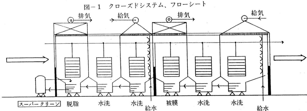
図-1に示す様に多段水洗方法を用い一定必要量の新鮮水を順次前段の水洗槽に流し、脱脂及被膜槽にもどす。その場合に脱脂液の油汚染されないようにするためにスーパークリーンの脱油(S S共)システムにより、脱脂槽の油分濃度を低水準にして油分汚染の進行を防止すれば完全クローズド化が理想的に効果づけることが可能となる。
